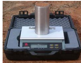
图 3. 确定现场土的湿密度。
