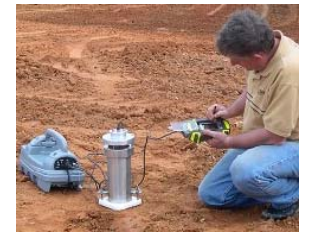
图 4. 对现场实地地上进行 TDR 测试。
